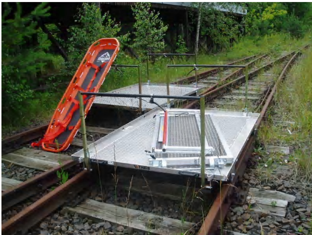
Mit den Transportwagen des Bahnrettungssatzes lassen sich Verletzte, Geräte und Werkzeuge von und zu Einsatzstellen transportieren.
