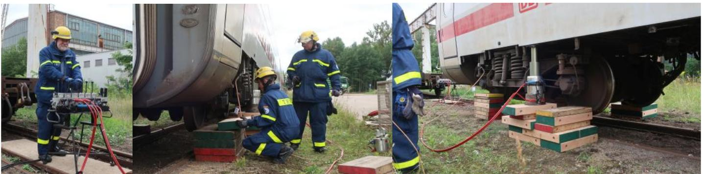
Am Güterwaggon nutzten wir die mittelschweren Heber, die bei zweiter Ausfahrstufe auf je 25 t Last ausgelegt sind, sowie eine Menge Unterbauholz. Fotos: Daniel Förder
